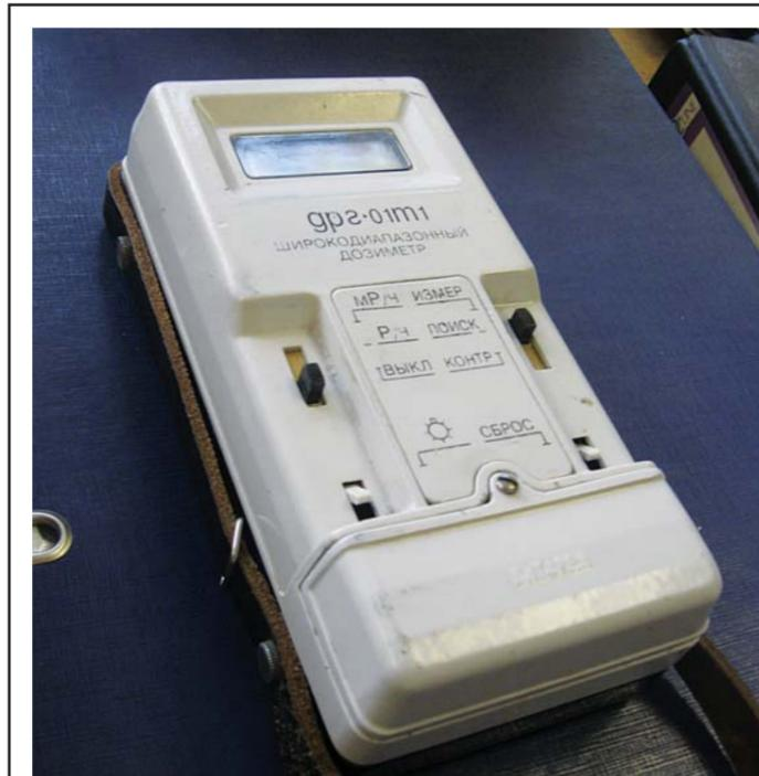
**Дозиметр-радиометр ДРГ-01Т1 отличается дизайном, двухтональной звуковой сигнализацией, повышением запрограммированных пороговых уровней**
