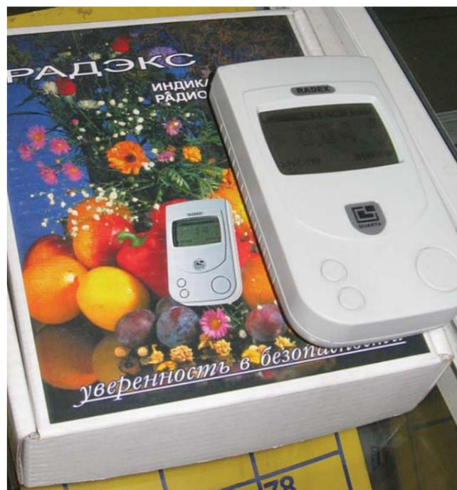
**«Радэкс 1503» предназначен для оценки мощности дозы гамма-излучения населением в бытовых условиях**
